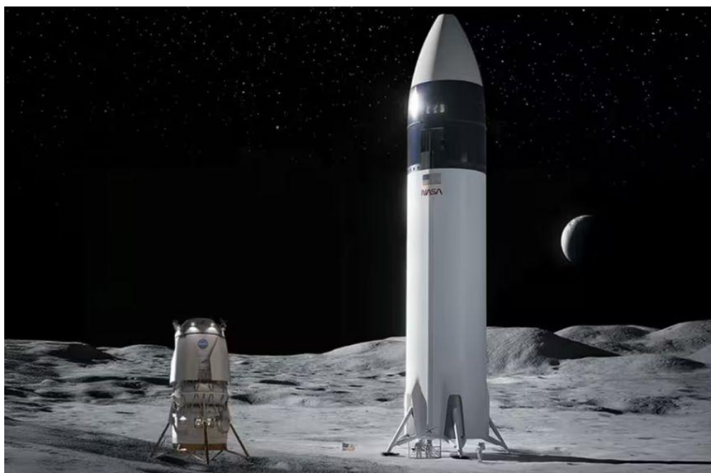
Рис. 6 – Изображения посадочного модуля Blue Moon HLS и корабля Starship HLS (второй ступени ракеты-носителя) на поверхности Луны
